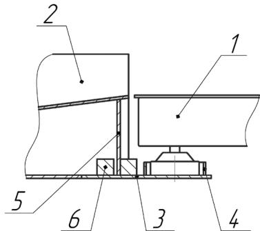
*Рис. 2 Схема соединения платформы и пандусов ВСП4-Б*
