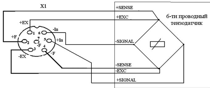
*Рисунок 6. Подключение 6-ти проводного датчика.*
