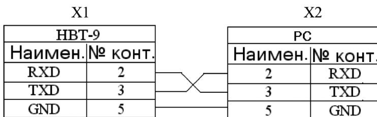
*Рисунок 5. Схема распайки интерфейсного кабеля.
